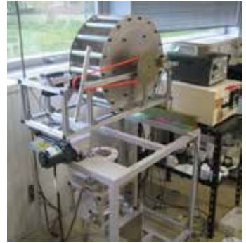
2点曲げ強度試験のためのガラスファイバー作製装置
