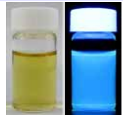
C-dotsの良好な水分散性(左)とUV照射下での蛍光特性(右)
